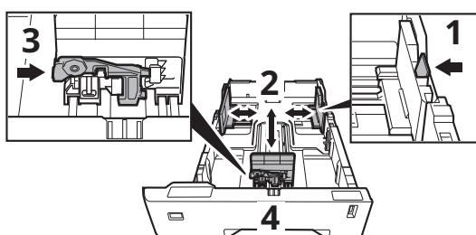
+ Se o papel for colocado sem ajustar a guia de comprimento do papel e as guias de largura do papel, ocorrerão distorções na alimentação do papel e um atolamento de papel.
