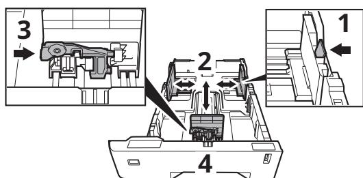
+ Si le papier est chargé sans réglage des guides de longueur et de largeur du papier, le papier risque d'être alimenté de travers et un bourrage papier risque de se produire.
